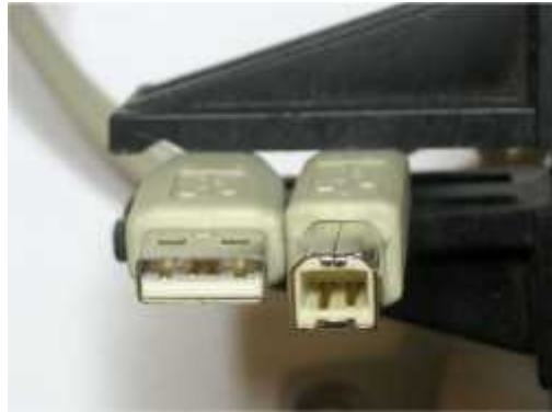
Figura 10 – Cavo con connettori USB (sinistra lato PC e destra lato scheda Arduino)
