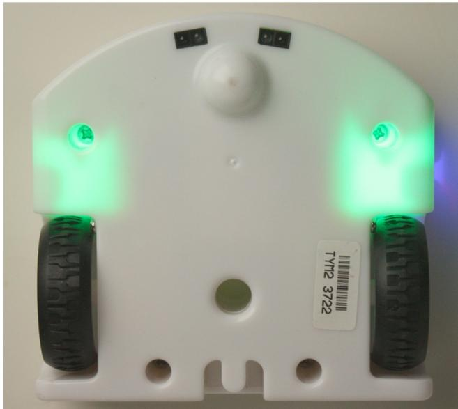
Figura 3.2: La parte inferiore del Thymio con i due sensori del terreno
